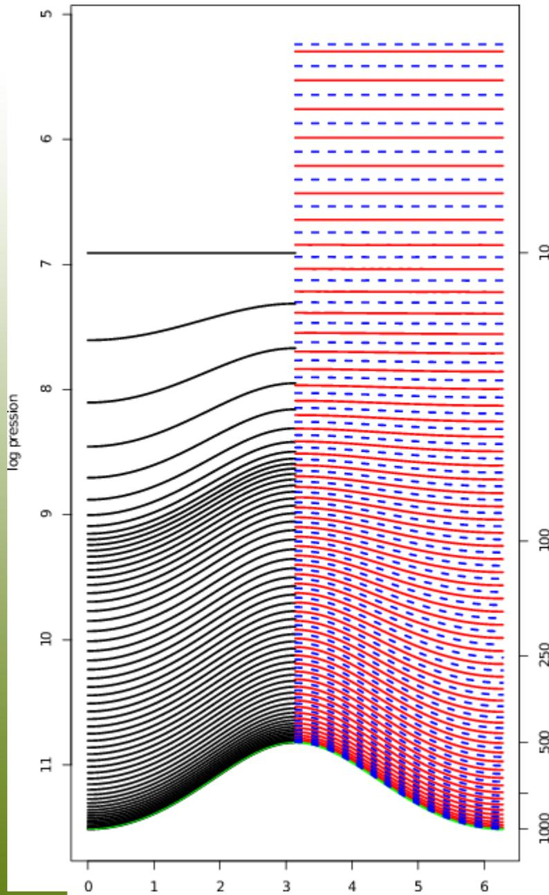
Dans le SPE opérationnel, l'information des vents, températures et de l'humidité est aux mêmes niveaux verticaux (côté gauche).
